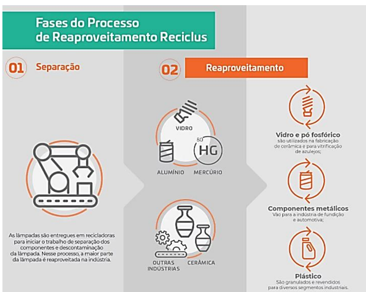
Figura 114: Fases do Processo de Reaproveitamento Reciclus
