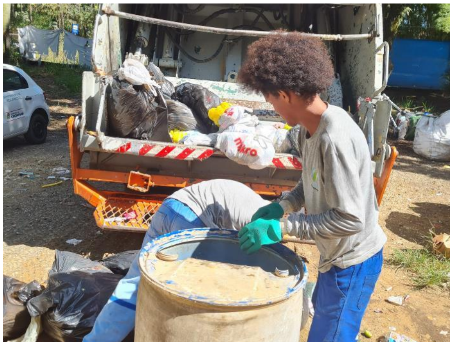
Figura 12: Enchimento da bombona para pesagem da amostra
